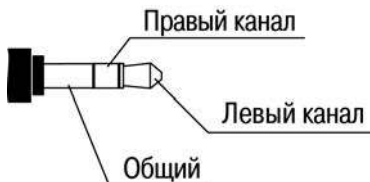
Рисунок 3.4 – Назначение контактов штекера для аудио-выхода
